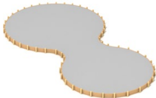
Grunden är en gjuten bottenplatta på marken.
