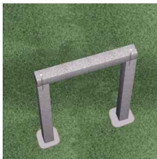
Armeringsjärnet hjälper till att stabilisera portalen. Hålen muras igen så att armeringsjärnet inte riskerar att rosta.
