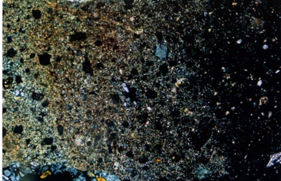
Karbonatisering i mikroskop. Foto taget av karbonatiseringsfront. Betongen är slipad så tunn att ljus kan penetrera genom betongen vilket gör det möjligt att identifiera komponenterna i polarisationsmikroskop. Kalciumhydroxid har låg medan kalcit har hög dubbelbrytning vilket medför att den karbonatiserade cementpastan till vänster på bilden blir ljus. De mörka och olikfärgade partiklarna är ballast. Ytan är 5 mm i verkligheten.
